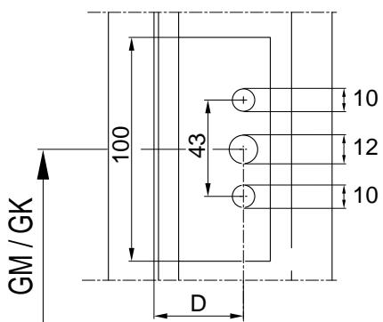
B-3-4: Сверление и фрезеровка GAK/GAM ...D 25 ...50
