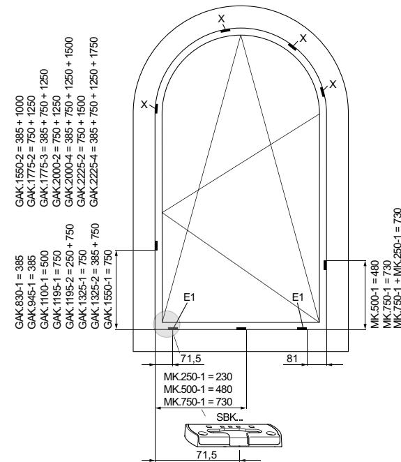
Места установки ответных планок "фиксированное положение ручки"
