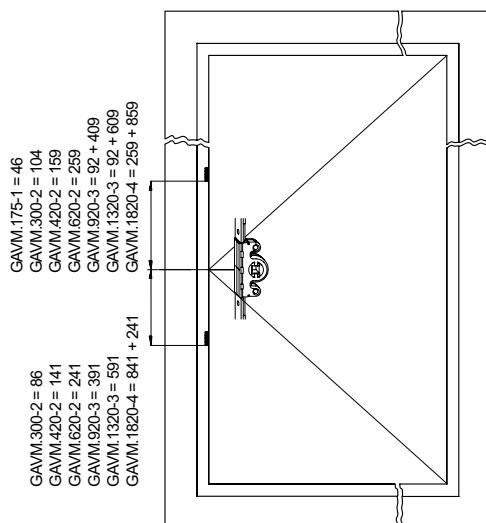
Места установки ответных планок в поворотных окнах с засовом GAVM
