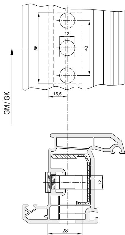
B-3-1: Сверление и фрезеровка GAK/GAM ..D = 15,5 мм
