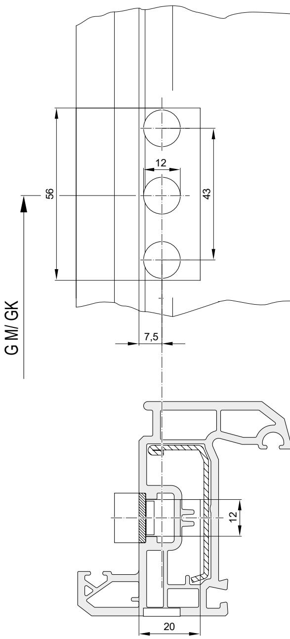
B-3-2: Сверление и фрезеровка GAK/GAM ..D = 7,5 мм
