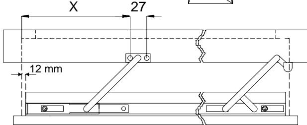
В-7-4: Рисунок монтажа дополнительного кронштейна ZSR
