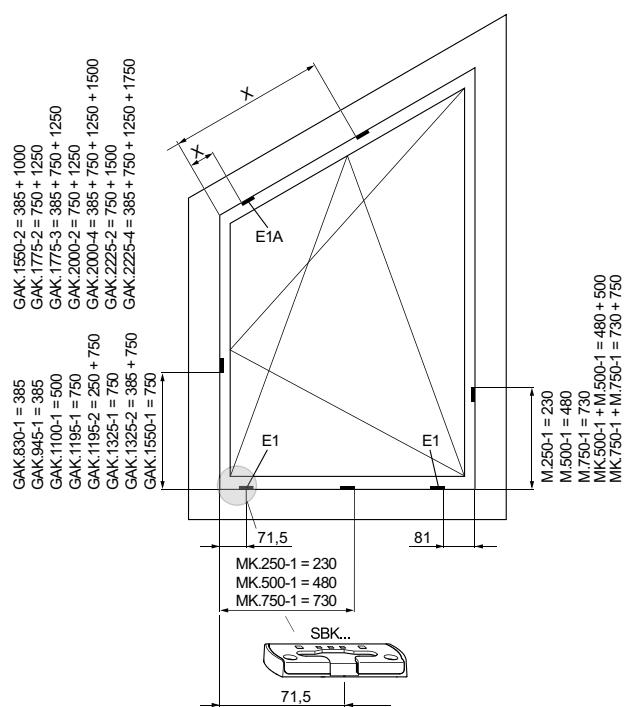
Места установки ответных планок "фиксированное положение ручки".
