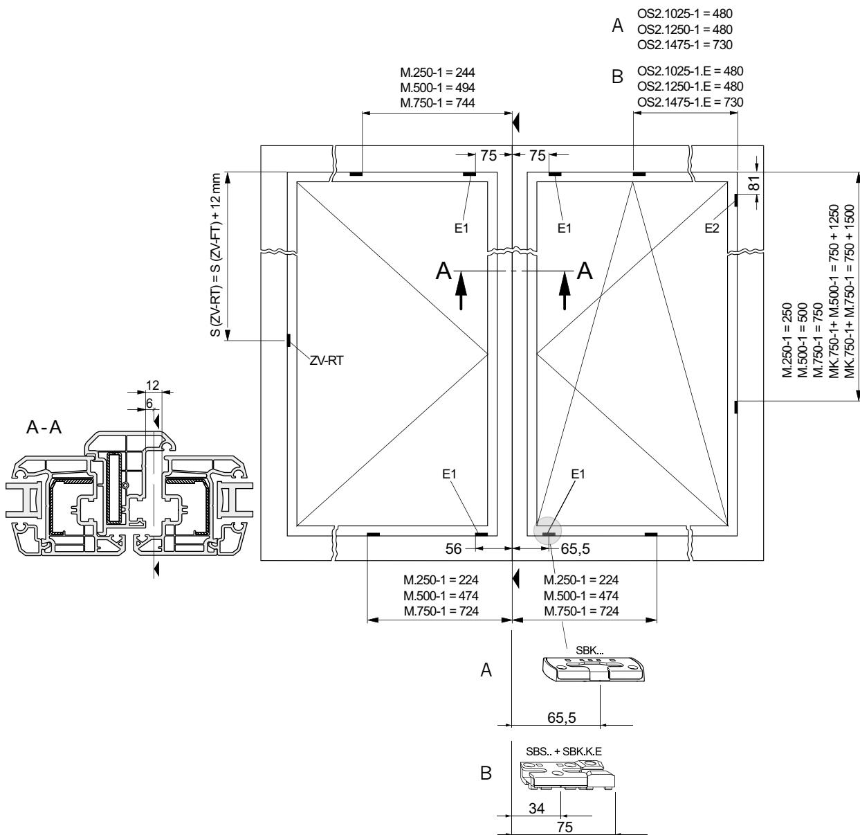
Места установки ответных планок для поворотно-откидного штульпового окна.
