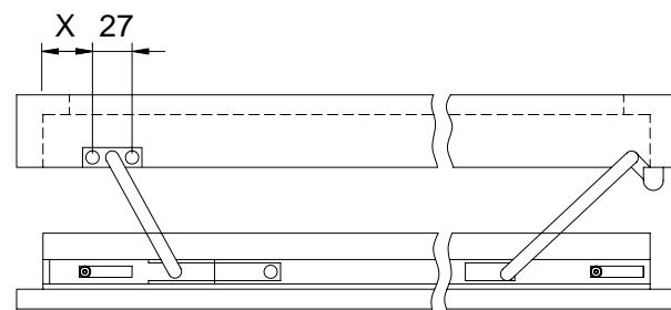
В-7-5: Рисунок монтажа дополнительного кронштейна ZSRE
