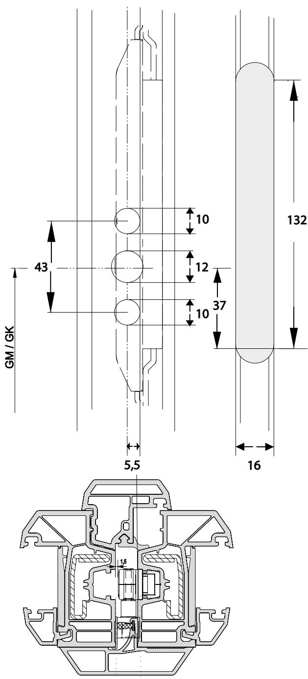
B-3-5: Чертежи для сверления и фрезерования GAK ...
