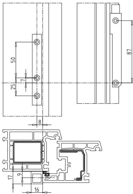
B-10-2: Сверление и фрезеровка под ограничитель открывания ОВУ
