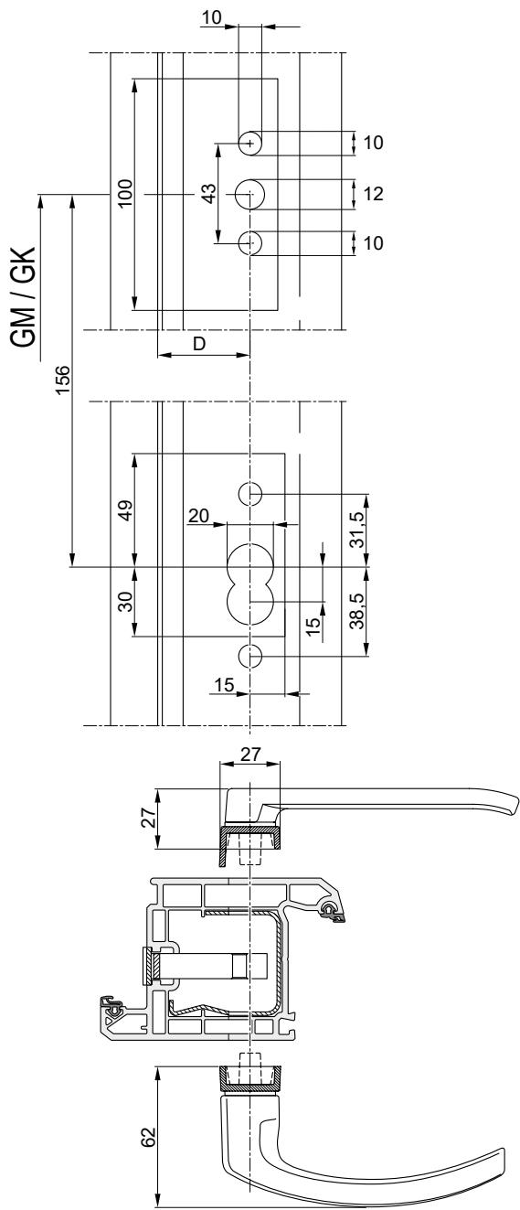
B-3-3: Сверление и фрезеровка GAKA/GAMA D ...
