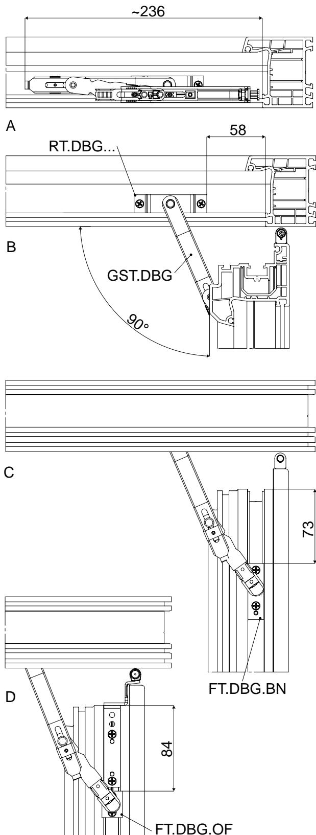
B-10-9: - Вид сверху А = DBG... закрыто; требуемое место на раме В = DBG... открыто на угол 90°; позиционирование ответных планок
